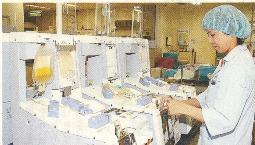
400ミリリットル献血で集まった血液を自動分離装置にかけ、赤血球と血漿に分離
